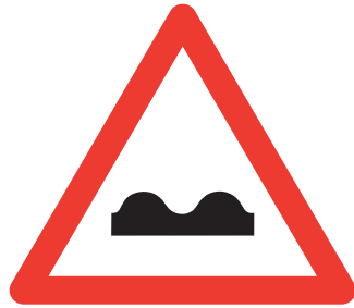
1.06 Unebene Fahrbahn (Art. 6)
